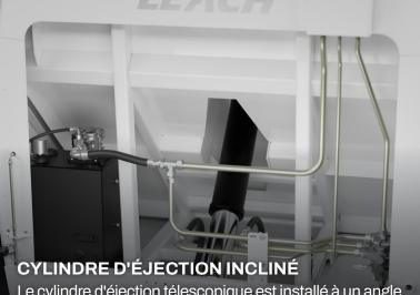
Le cylindre d'éjection télescopique est installé à un angle ascendant, le maintenant à distance des débris et dirigeant les forces de compactage loin du plancher de la benne et vers son emplacement de montage avant.
